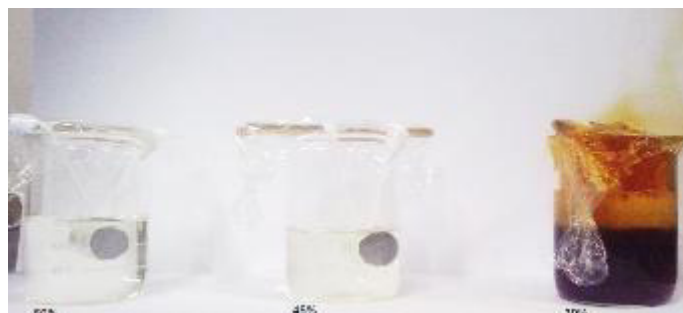
Figura 5 Ensaio de Imersão em 30, 45 e 50% durante 1h.
